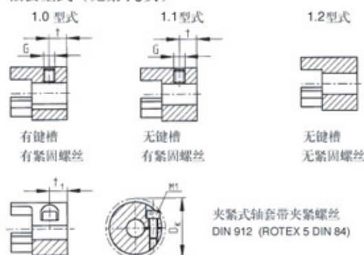
2.0 型式 夹紧式轴套，无键槽，传递扭矩取决于轴径 2.1 型式 夹紧式轴套，有键槽
